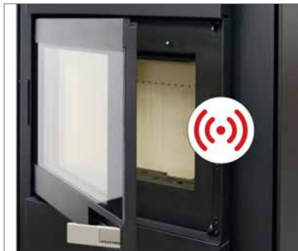
SENSORE ACUSTICO APERTURA PORTA Garantisce una migliore sicurezza di funzionamento della stufa. Con funzionamento a legna all'apertura della porta la serranda si apre automaticamente evitando l'uscita dei fumi nell'ambiente, con quello a pellet in caso di apertura della porta, la stufa si spegne automaticamente.
