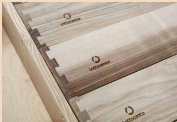
Il massello in frassino è l'essenza impiegata per le strutture interne dei cassetti, che vengono assemblate con incastri a coda di rondine. Per lo scorimento dei cassetti, vengono utilizzate guide autolubrificanti, a scomparsa ed ad estrazione totale, con meccanismo di richiamo ammortizzato per la chiusura.
