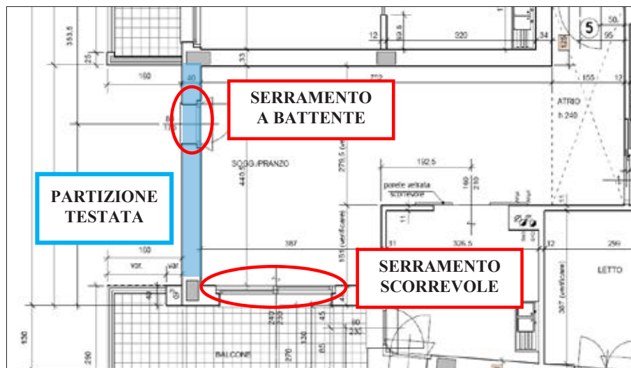
Fig. 9 – ambiente di misura con evidenziati i serramenti
