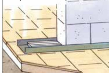
Appoggiate il primo blocco, senza incollarlo, alla parete verticale. Lasciate un piccolo spazio ( $d. \leq 1 \text{ cm}$ ).
