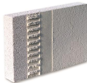
Multipor è un pannello isolante in idrati di silicato di calcio autoclavato, prodotto da materie prime naturali come sabbia, calce ed acqua, con l'aggiunta di una piccola percentuale di cemento e di additivi porizzanti.
