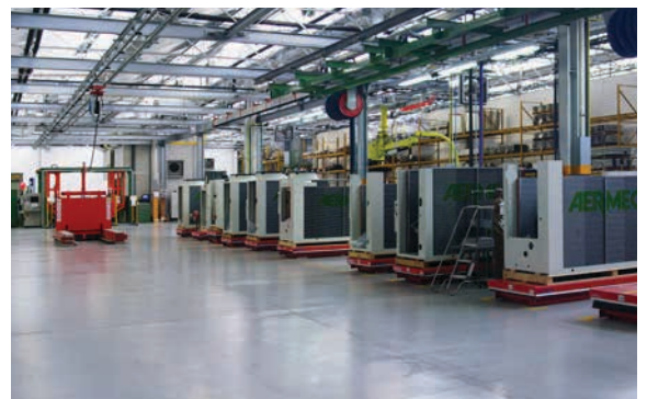
Linea di montaggio di macchine di media potenza
