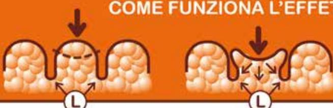
La particolare sezione ad onda permette di distribuire l'urto tra i vari spazi concavi laterali **(L)** ammortizzando la potenza dell'urto
