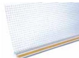
Profilo in PVC con nastro di guarnizione autoadesivo in PE da applicare al telaio della finestra o di altro elemento per garantire un raccordo a tenuta di pioggia battente. Dotato di aletta protettiva adesiva asportabile che permette la protezione del serramento durante la posa.
