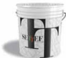
Collante e rasante in pasta a base di resine in emulsione acquosa alcali resistenti, sabbie silicee, inerti micronizzati a granulometria calibrata e additivi specifici da additivare con 1 parte di cemento ogni 2 parti di prodotto. Colore: grigio.
