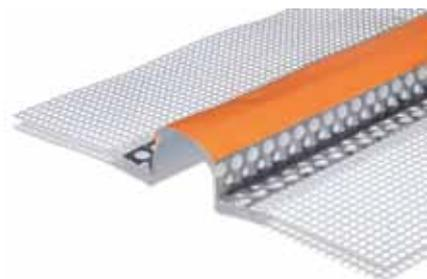
Giunto in PVC con guaina in caucciù sovraverniciabile e rete in fibra di vetro preaccoppiata da inserire tra i pannelli isolanti in presenza di giunti strutturali dell'edificio.
