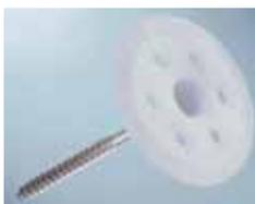
Tassello ad avvitamento con rondella per legno e lamiere metalliche. Possibilità di montaggio a filo o ad incasso nell'isolante, con tappi isolanti di chiusura. Profondità di ancoraggio: 30 mm.
