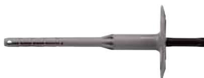
Tassello ad espansione con chiodo in acciaio termicamente protetto utilizzato per il fissaggio meccanico supplementare dei pannelli isolanti. Omologato secondo l'ETAG 014 per categorie d'uso A,B,C,D. Profondità di ancoraggio: 40 mm.
