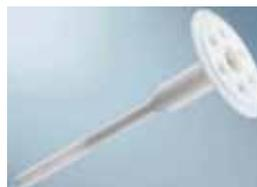
Tassello universale con vite in acciaio utilizzato per il fissaggio meccanico supplementare dei pannelli isolanti. Possibilità di montaggio a filo o ad incasso nell'isolante, con tappi isolanti di chiusura. Omologato secondo l'ETAG 014 per categorie d'uso A,B,C,D,E. Profondità di ancoraggio: 25 mm (60 mm per cat.E).
