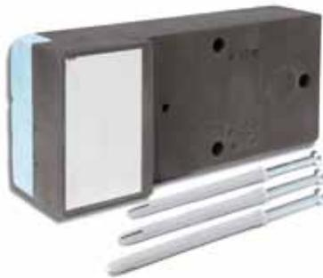
Supporto in schiuma poliuretana rigida, con incorporate due piastre in resina fenolica da utilizzarsi come supporto per il montaggio senza ponti termici di carichi pesanti (cardini d'imposte, ringhiere, parapetti, ecc.).
