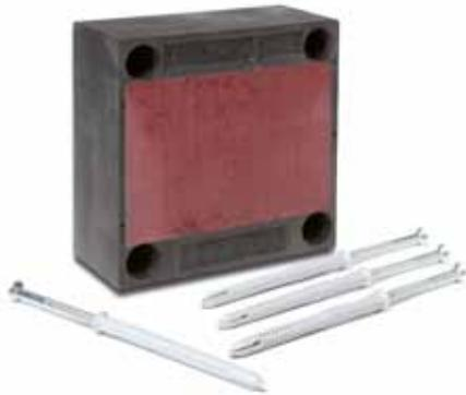
Elemento in schiuma poliuretana rigida, rinforzato internamente con una piastra d'acciaio e superiormente con una piastra di alluminio iniettata con schiuma per l'avvitamento degli elementi esterni pesanti in facciata senza ponti termici (es. corrimano, ringhiere, tende parasole ecc.).
