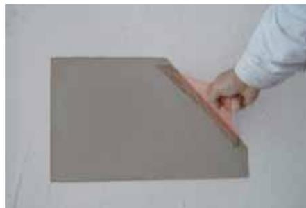
*Applicazione di una rasatura armata su di una porzione di 30x30 cm con il collante del sistema*
