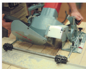
La ZK 115 Ec con barra guida.
