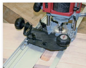
Il dispositivo per fianco scala per fresature di 640 x 60 mm fa parte dell'accessoriamento speciale.
