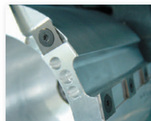
La nuova testa portafresa con le sue placchette ribaltabili in metallo duro comporta un'insuperabile capacità di truciatura, migliorando nel contempo l'evacuazione dei trucioli.
