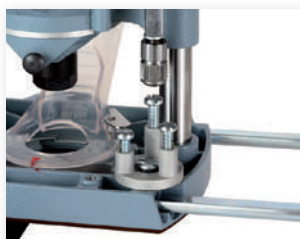
Regolazione della profondità di fresata grazie alla battuta a revolver a tre regolazioni.
