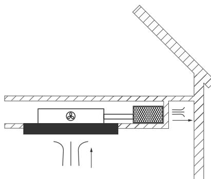
**Motore slim con unità filtrante Carbon.Zeo verticale.**
