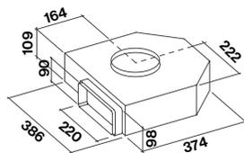
Esempio di installazione del raccordo per la cappa Piano a un elemento e motore sottobase con evacuazione aria a sinistra.
