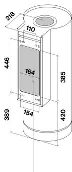
Uscita posteriore: rimuovere il tampono 385x164 mm.
