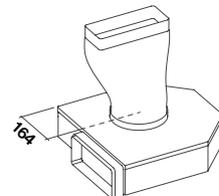
Esempio di installazione del raccordo per la cappa Piano a due elementi e motore sottobase con evacuazione aria a destra.
