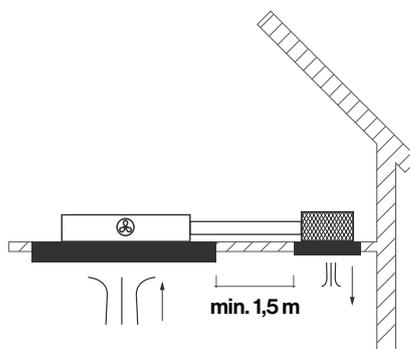
**Motore slim con unità filtrante Carbon.Zeo/E.ion.®**
