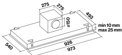
Motore sottotetto installato sulla cappa
