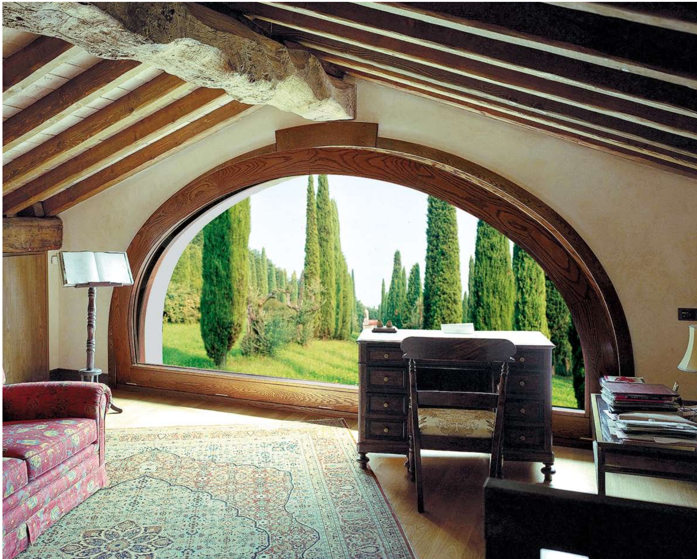
Serramento SC 120 in rovere esecuzione speciale ad arco con apertura a vasistas motorizzato Dimensione cm 400 x 230
