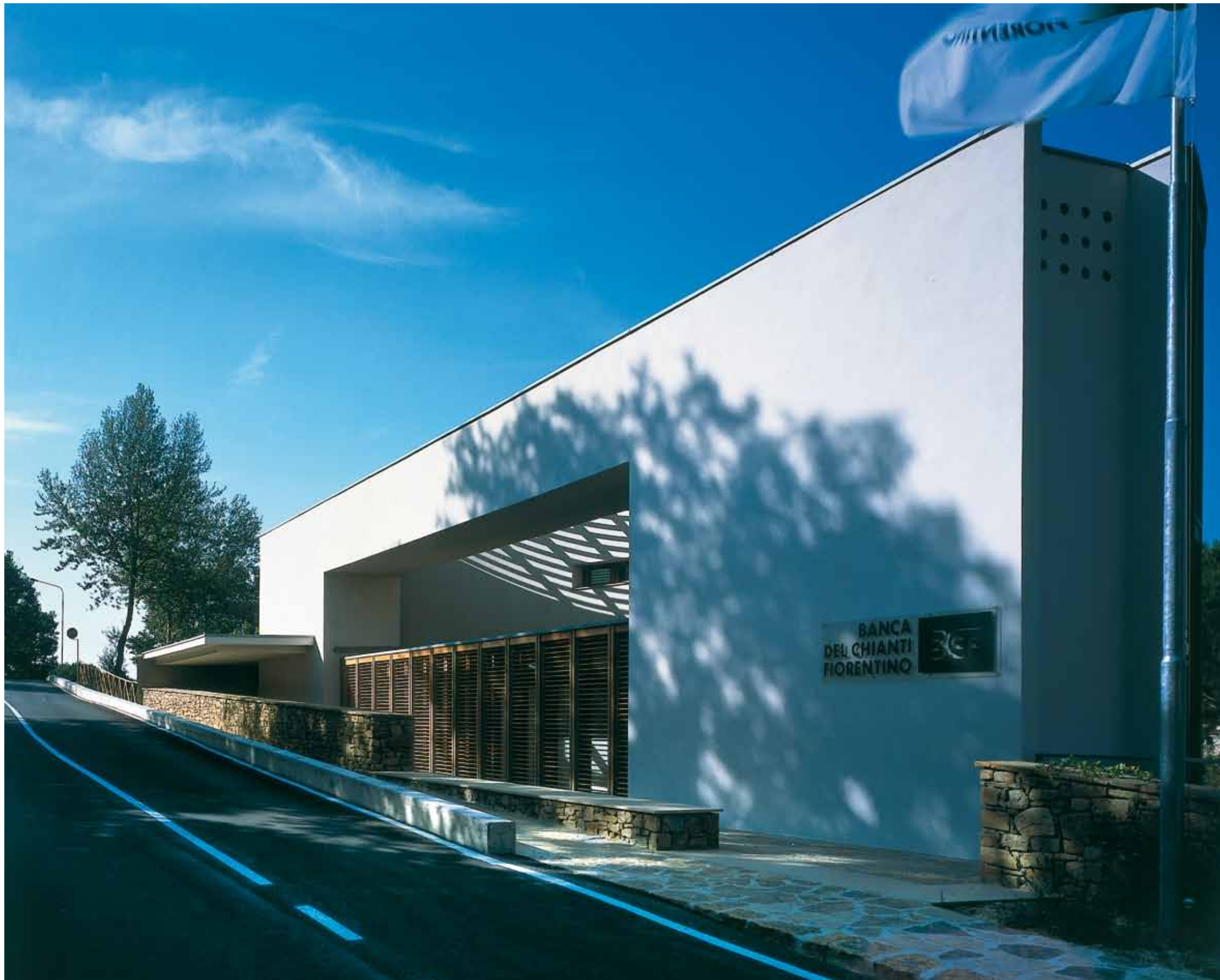
Serramenti SC 70 con lamelle frangisole in legno orientabili e impacchettabili Windows in SC 70 complete with stackable, fully adjustable wooden sunbreakers
