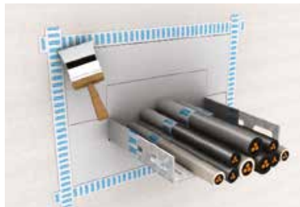
9. Applicare lo spessore corretto di PROMASTOP®-I sulla lana minerale (nel caso in cui i pannelli non siano già pre-trattati) e riempire gli spazi rimanenti. I cavi dovranno essere pitturati. Ripetere l'operazione sul lato opposto se necessario.
