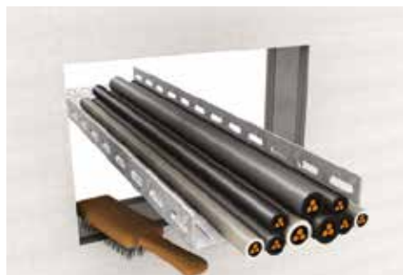
1. Pulire l'apertura dell'area di attraversamento
