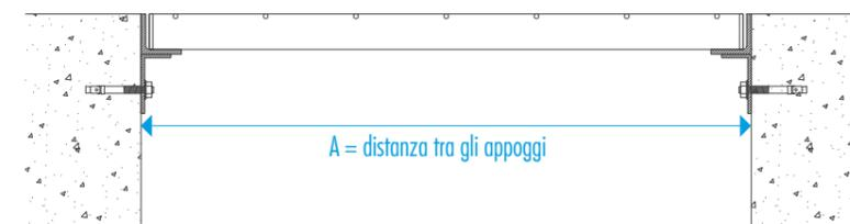
Bocca di lupo con TELAIO IN ANGOLARE DA ANNEGARE (ad isola)
