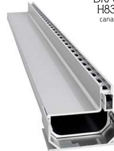
Canale in alluminio estruso con fessure di ingresso longitudinali continue 10x25mm e giunto preassemblato di serie per garantire un allineamento perfetto e un assemblaggio rapido. Il profilo in alluminio è dotato di uno strato anodizzato da 15 µm che rende il profilo duraturo e resistente alla corrosione. Lo spessore di riempimento è 40 / 73 mm.
