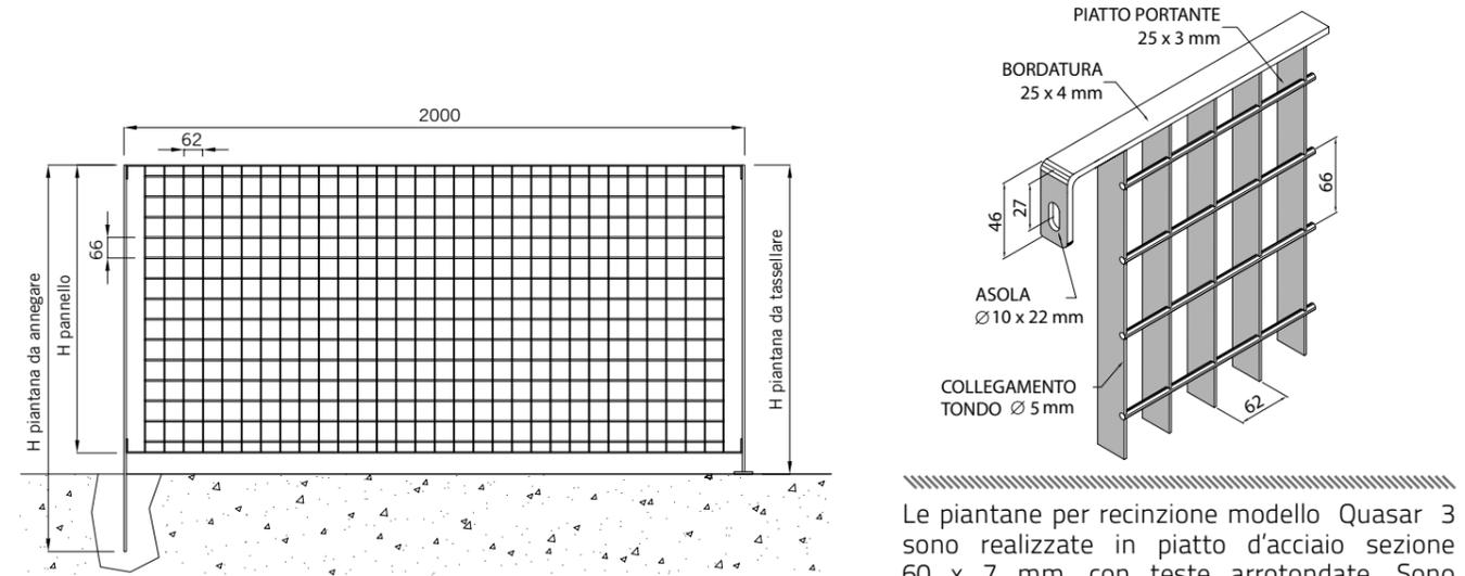
Le piantane per recinzione modello Quasar 3 sono realizzate in piatto d'acciaio sezione 60 x 7 mm, con teste arrotondate. Sono disponibili nelle varianti da annegare e da tassellare.
