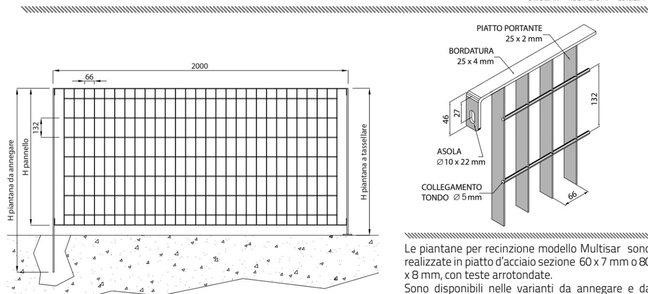
Le piantane per recinzione modello Multisar sono realizzate in piatto d'acciaio sezione 60 x 7 mm o 80 x 8 mm, con teste arrotondate. Sono disponibili nelle varianti da annegare e da tassellare.
