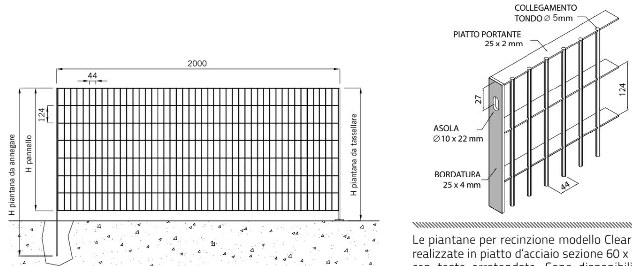
Le piantane per recinzione modello Clear sono realizzate in piatto d'acciaio sezione 60 x 7 mm, con teste arrotondate. Sono disponibili nelle varianti da annegare e da tassellare.
