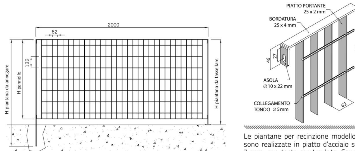
Le piantane per recinzione modello Multisar 2 sono realizzate in piatto d'acciaio sezione 60 x 7 mm, con teste arrotondate. Sono disponibili nelle varianti da annegare e da tassellare.
