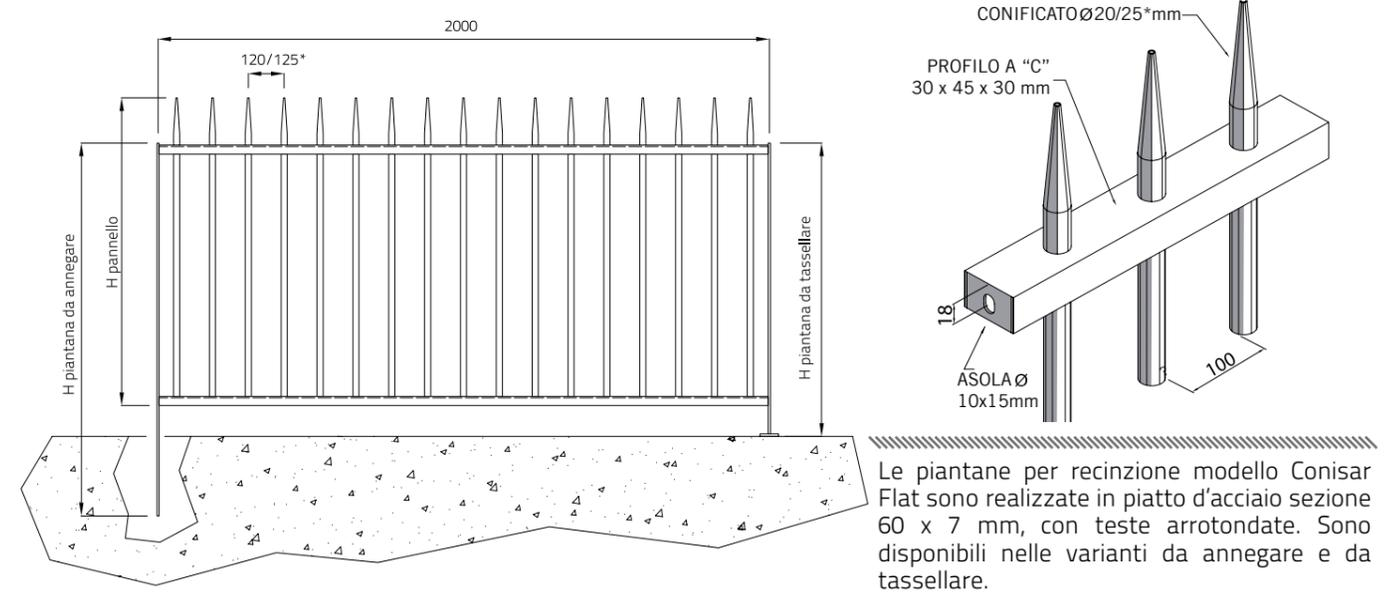
Le piantane per recinzione modello Conisar Flat sono realizzate in piatto d'acciaio sezione 60 x 7 mm, con teste arrotondate. Sono disponibili nelle varianti da annegare e da tassellare.
