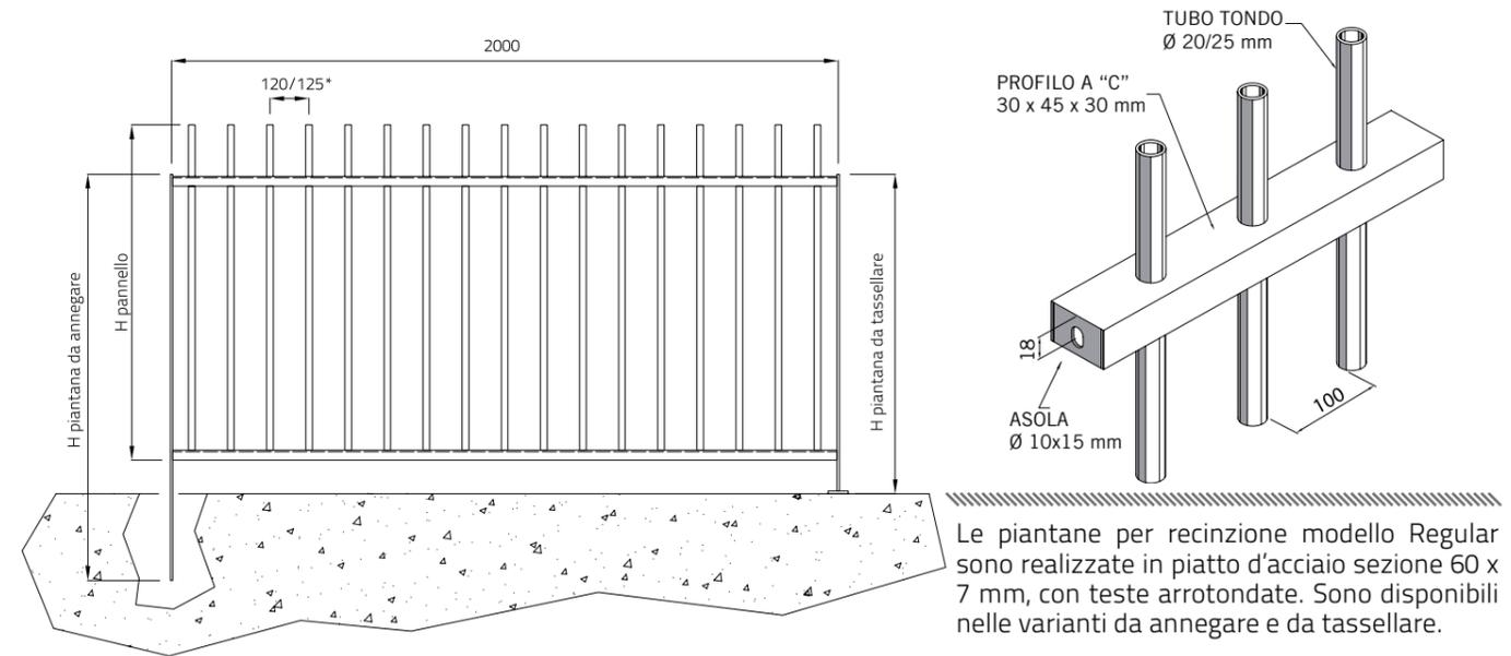
Le piantane per recinzione modello Regular sono realizzate in piatto d'acciaio sezione 60 x 7 mm, con teste arrotondate. Sono disponibili nelle varianti da annegare e da tassellare.
