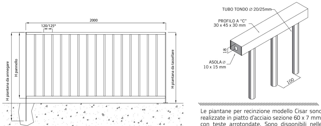
Le piantane per recinzione modello Cisar sono realizzate in piatto d'acciaio sezione 60 x 7 mm, con teste arrotondate. Sono disponibili nelle varianti da annegare e da tassellare.
