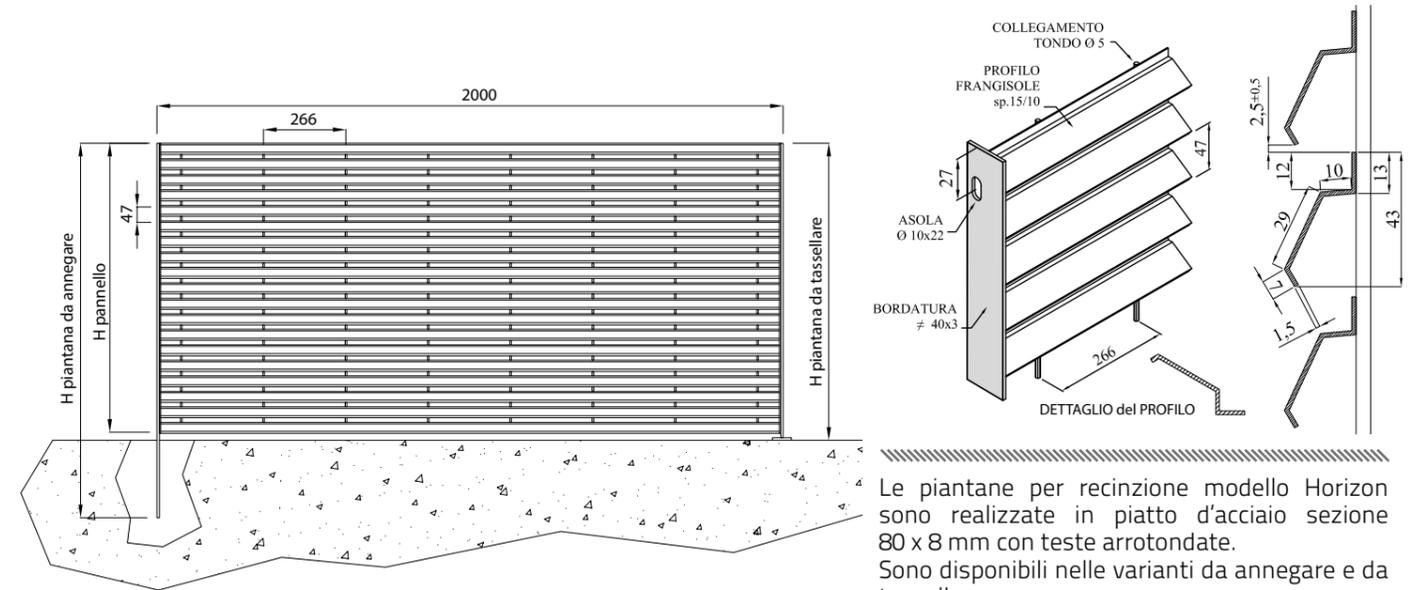
Le piantane per recinzione modello Horizon sono realizzate in piatto d'acciaio sezione 80 x 8 mm con teste arrotondate. Sono disponibili nelle varianti da annegare e da tassellare.
