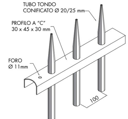
Le piantane per recinzione modello Conisar sono realizzate in tubo tondo, diam. 60 mm, conificato all'estremità superiore. Sono disponibili nelle varianti da annegare e da tassellare.
