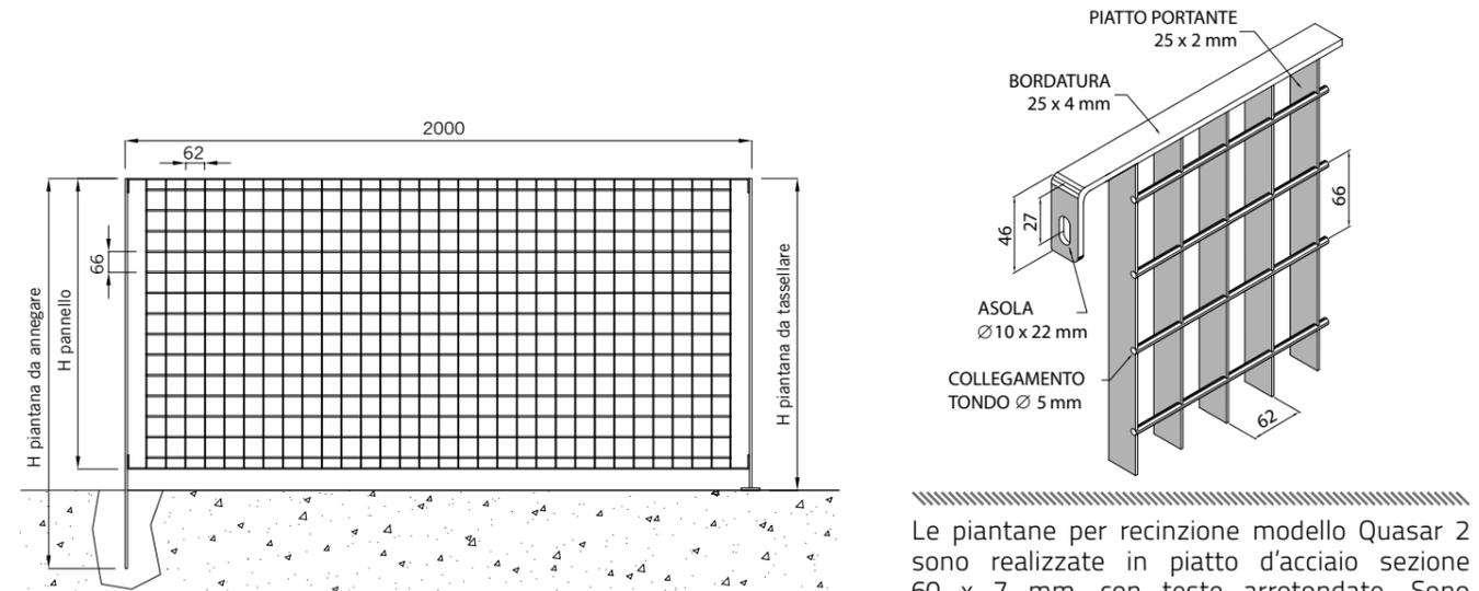
Le piantane per recinzione modello Quasar 2 sono realizzate in piatto d'acciaio sezione 60 x 7 mm, con teste arrotondate. Sono disponibili nelle varianti da annegare e da tassellare.
