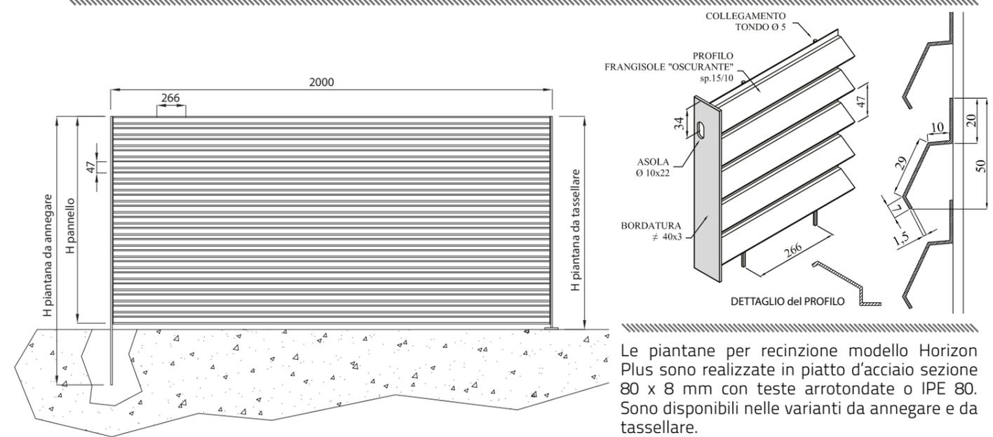
Le piantane per recinzione modello Horizon Plus sono realizzate in piatto d'acciaio sezione 80 x 8 mm con teste arrotondate o IPE 80. Sono disponibili nelle varianti da annegare e da tassellare.
