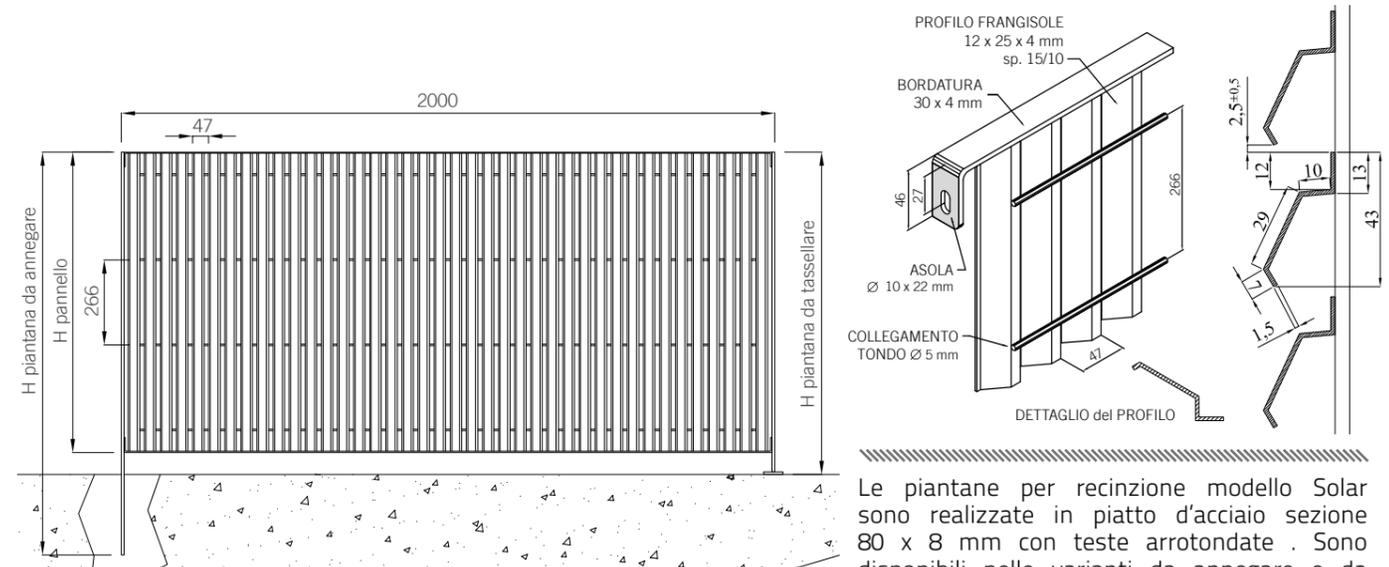
Le piantane per recinzione modello Solar sono realizzate in piatto d'acciaio sezione 80 x 8 mm con teste arrotondate. Sono disponibili nelle varianti da annegare e da tassellare.
