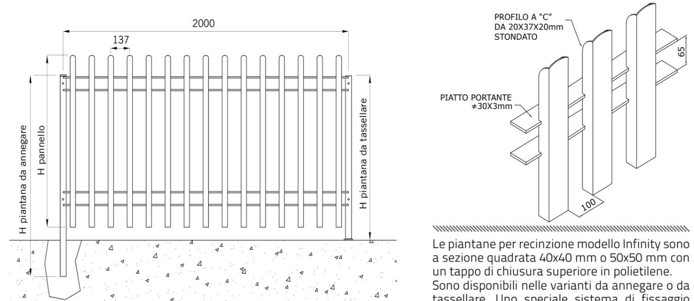
Le piantane per recinzione modello Infinity sono a sezione quadrata 40x40 mm o 50x50 mm con un tappo di chiusura superiore in polietilene. Sono disponibili nelle varianti da annegare o da tassellare. Uno speciale sistema di fissaggio dei pannelli rende la posa semplice e flessibile anche per la realizzazione di terminali a misura.
