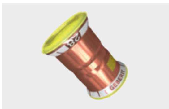
↑ I raccordi Geberit Mapress Rame sono adatti a numerosi campi d'applicazione, ad esempio quelli per le condotte del gas hanno l'O-ring e l'indicatore di pressatura giallo.
