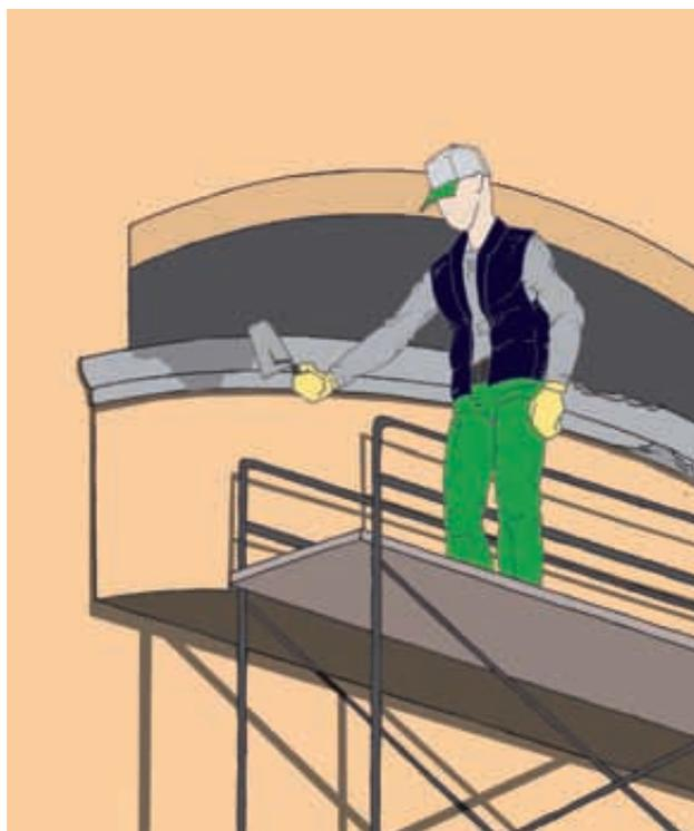
2) Ricostruzione della superficie eseguita con Nai Cm Ripristino, fino a 5 cm con una sola mano.
