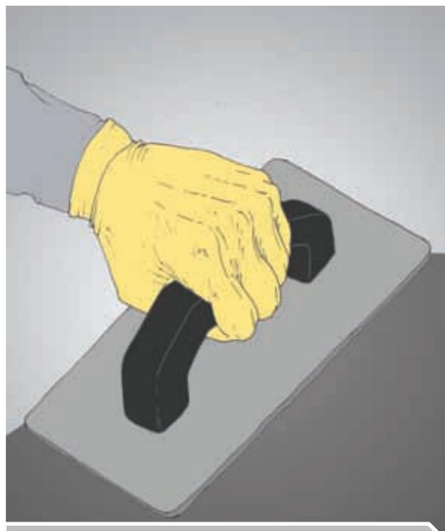
6) Ripetere la lavorazione sovrapplicando un ulteriore strato dopo che il precedente sia asciutto ed entro le 24 ore successive. Il prodotto diventa completamente carrabile dopo 5 gg. a temperatura di 23 °C.
