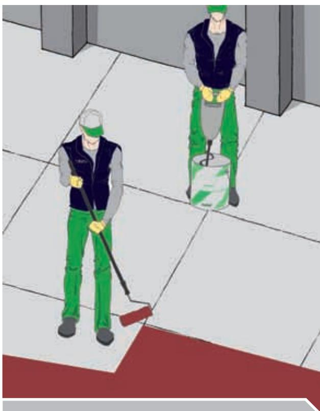
3) Applicazione di una mano di Neutral Coat/S sulla superficie per un consumo medio di ca. 150 gr/mq.
