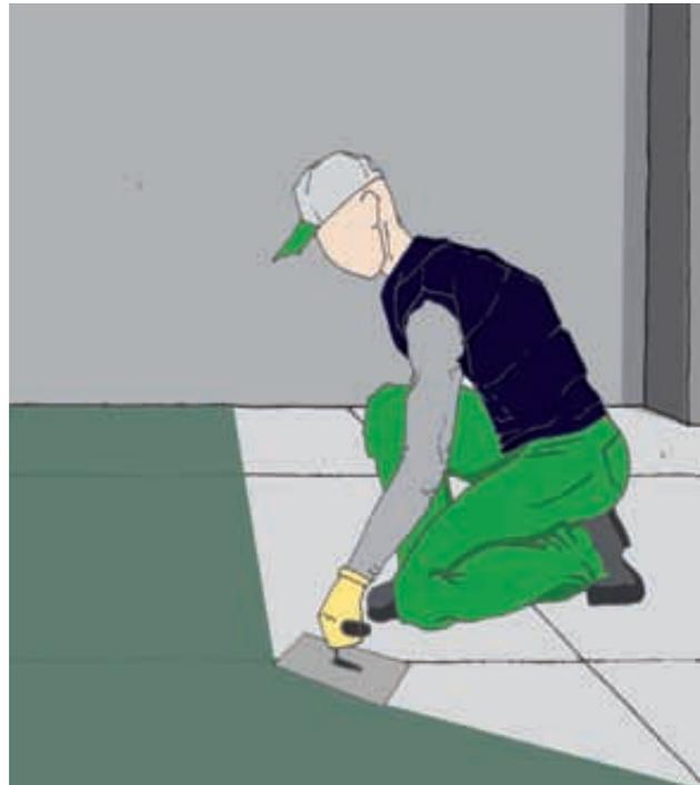
4) Applicare in un'unica mano il Nairetan Malta Autolivellante, utilizzando una spatola dentata, per un consumo medio di ca 3 kg/mq. Passare sul prodotto fresco il rullo frangibolle (indossando scarpe chiodate) per evitare la formazione di bolle d'aria.
