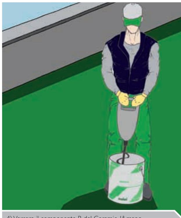
4) Versare il componente B del Ceramic 1<sup>a</sup> mano nel componente A e mescolare accuratamente con miscelatore munito di apposita girante. Aggiungere il componente C e mescolare nuovamente fino a che i componenti siano perfettamente amalgamati.
