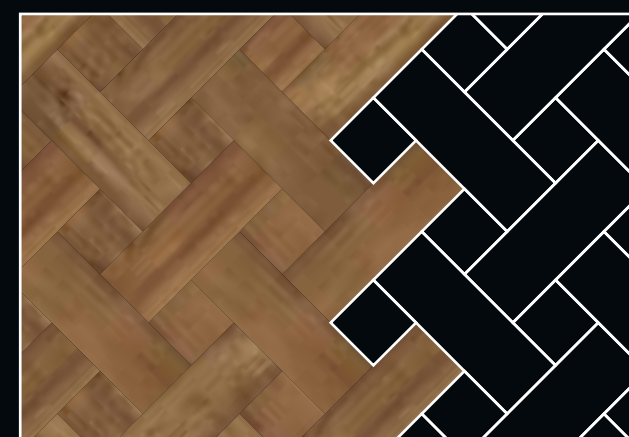
Korbgeflecht-Verlegung Basket weave
