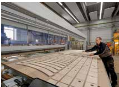
Grazie alle più evolute macchine CNC, i pannelli vengono tagliati con massima precisione e secondo le specifiche di progetto, elaborate con PERI CAD.
