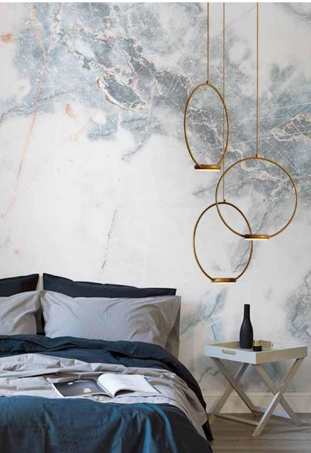
Famiglia di lampade a sospensione in tubo e lastra d'acciaio verniciati a polveri epossidiche. Diffusore superiore ed inferiore in metacrilato satinato per la doppia emissione di luce.
