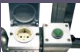
Presca elettrica da 230V posizionata sul cestello
