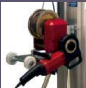
Dispositivo per elevazione mediante trapano potente
