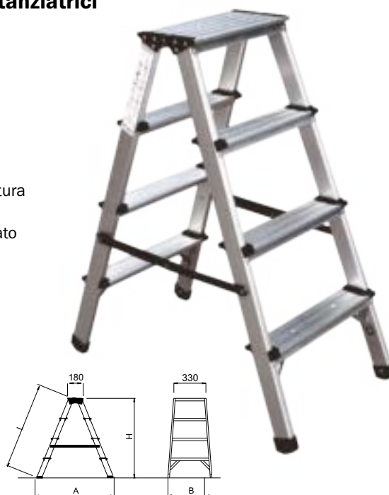
Gradino piano profondo mm. 80 con zigrinatura anti-scivolo
