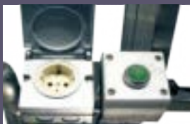
Presse elettrica da 230V posizionata sul cestello
