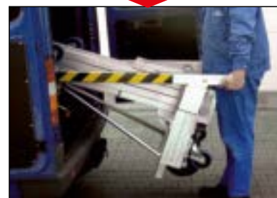
E' possibile ripiegare le barre di sostegno mediante dispositivo con sblocco rapido senza l'ausilio di utensili per consentirne il trasporto anche su piccoli automezzi.
