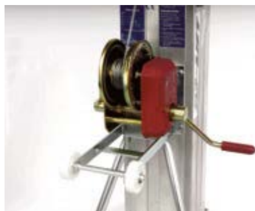
Elevazione mediante argano AL-KO professionale a manovella
