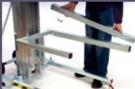
Prolungha per forche ad inserimento telescopico e bloccaggio con spina passante
