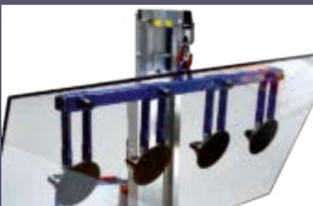
Barra a ventose per il montaggio di vetrate a parete o su superfici semi-verticali
