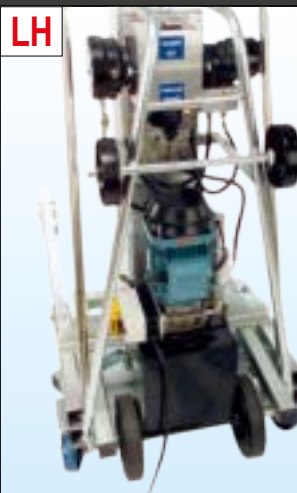
Elevazione elettrico-idraulica 230 V con leve di comando
