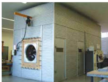
Tunnel aerodinamici per determinare le prestazioni di portata-pressione dei ventilatori.
