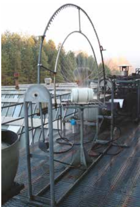
Invecchiamento del prodotto esposto alle intemperie
