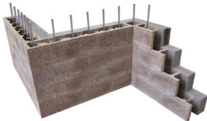
■ Particolare di posa a secco dei blocchi e riempimento degli stessi Mediante calcestruzzo e inserimento armatura
