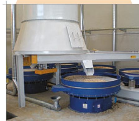
■ Prima di essere utilizzato per la produzione, il legno, viene setacciato per eliminare la segatura e la polvere (procedimento Necessario ai sensi della norma UNI EN 14474), le quali, creerebbero in seguito problemi di risalita di umidità e in fase di intonacatura.
