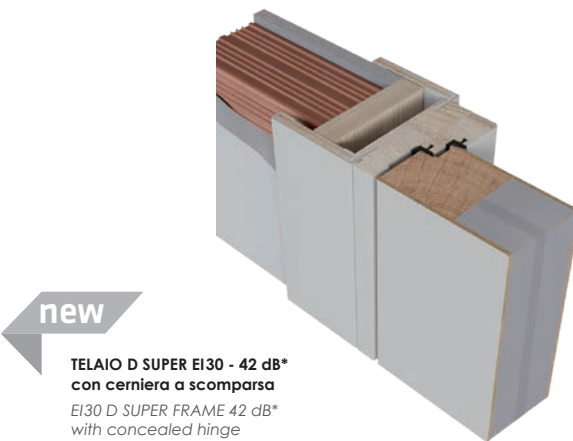
TELAIO EI30 con cerniera a scomparsa e/o a bandella EI30 FRAME with flap concealed hinge
