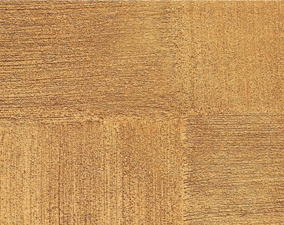
EFFETTO SPAZZOLATO Decorazione ottenuta applicando uno strato di Marmorino (T106) a frattazzo; 2° strato con spazzola in fibra naturale. Finitura con Velature (A652). BRUSHED EFFECT Decoration obtained by applying one coat of Marmorino (T106) by trowel and a second coat using a pure bristle brush. Finish with Velature (A652).
