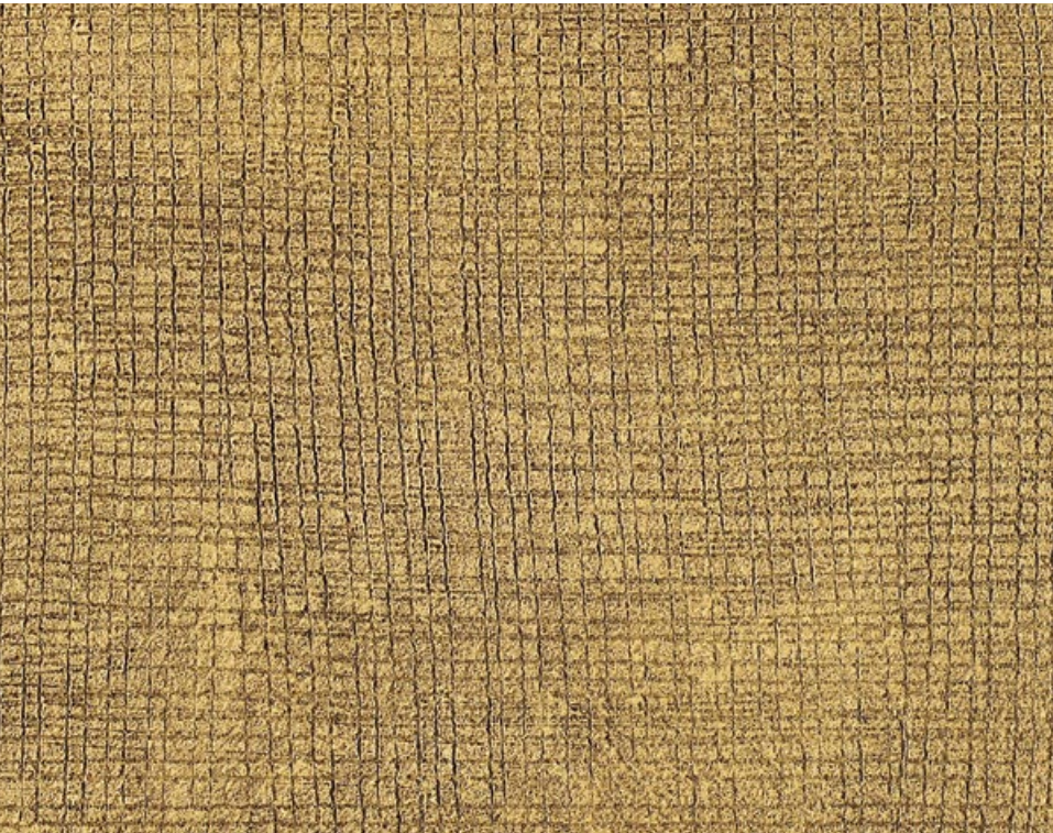
EFFETTO RETE Decorazione ottenuta applicando uno strato di Marmorino (T106) a frattazzo; 2° strato con pettine semplice (denti in metallo). Finitura con Velature (A641). MESH OR COMBED EFFECT Decoration obtained by applying one coat of Marmorino (T106) by trowel and a second coat using a simple comb (metal teeth). Finish with Velature (A641).
