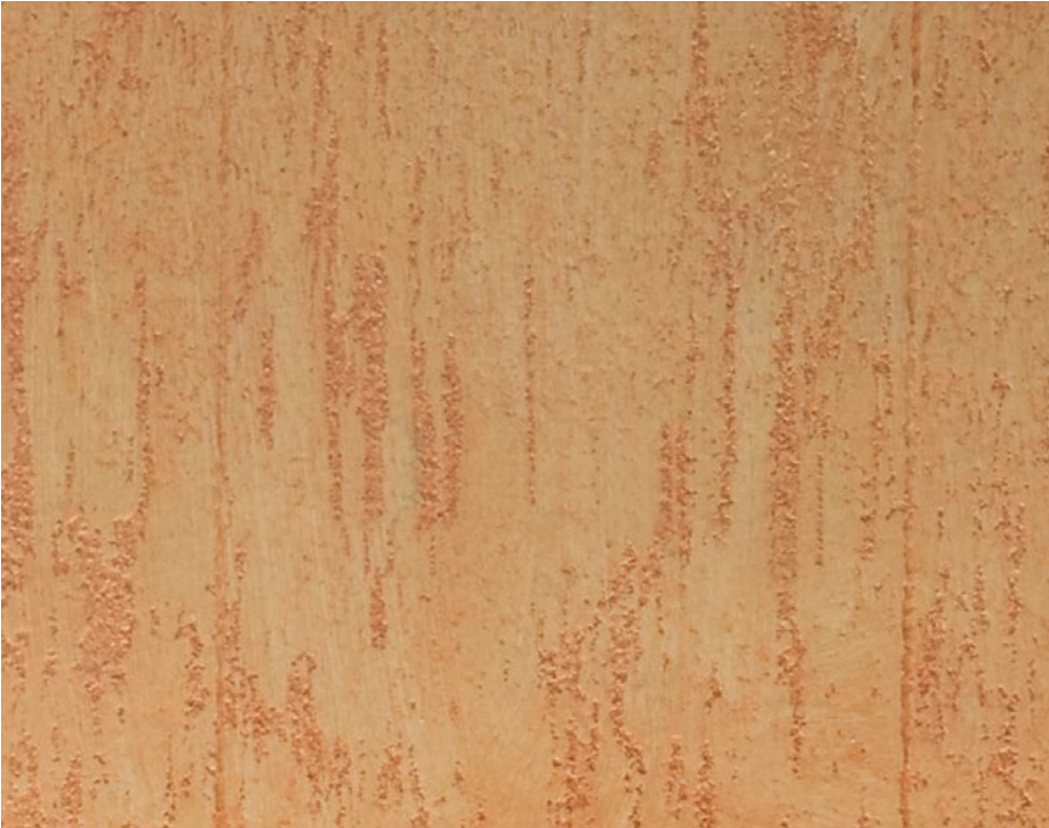
EFFETTO MARMO ANTICIZZATO Decorazione ottenuta dalla combinazione di Marmo antico e Velature. Su fondo preparato con due strati di Marmo antico, asciutto e lucindato, applicare uno strato di Velature. ANTIQUE MARBLE EFFECT Decoration obtained from the combination of the Marmo antico and Velature products. Apply one coat of Velature to a dry and polished base made up of two coats of Marmo antico.
