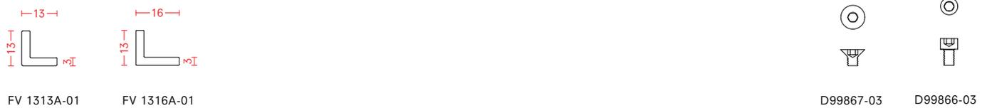
inglesine in acciaio laminato a caldo (-01) e acciaio sabbiato/pallinato (-14) - lunghezza barre 5800 mm
