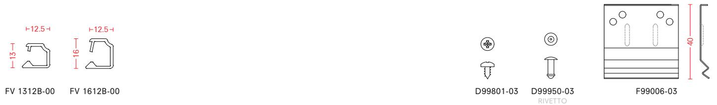
fermavetri a scatto in acciaio - lunghezza barre fermavetri 5800 mm
