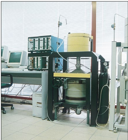
Analisi per il controllo dell'inquinamento da isotopi gammaemittenti presso il Laboratorio di Spettrometria Nucleare del CRAD
