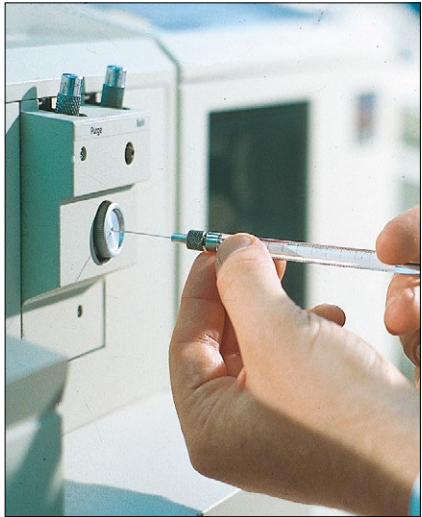
L'aria inquinata dalla vernice sintetica viene prelevata e immessa nel gas-cromatografo per l'analisi dei componenti presenti
