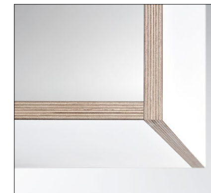
Dopo esposizione per 60 minuti a 150°C: nessuna deformazione
