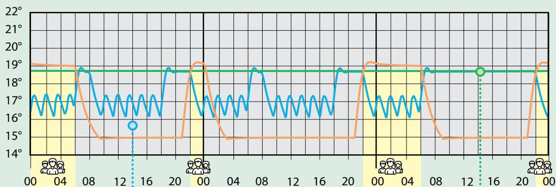
Seguendo la programmazione della zona giorno, la regolazione tramite cronotermostato non può garantire il comfort negli altri ambienti e determina uno spreco di energia.
