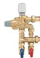
Utilizzabile negli impianti idrosanitari per il controllo dell'acqua calda e fredda distribuita all'utenza. Un miscelatore termostatico regolabile ad alte prestazioni mantiene la temperatura dell'acqua calda al valore desiderato e protegge l'utente dal pericolo di scottature. Una valvola di flusso permette di effettuare la disinfezione termica del circuito fino al rubinetto, nel rispetto delle disposizioni normative antilegionella.
