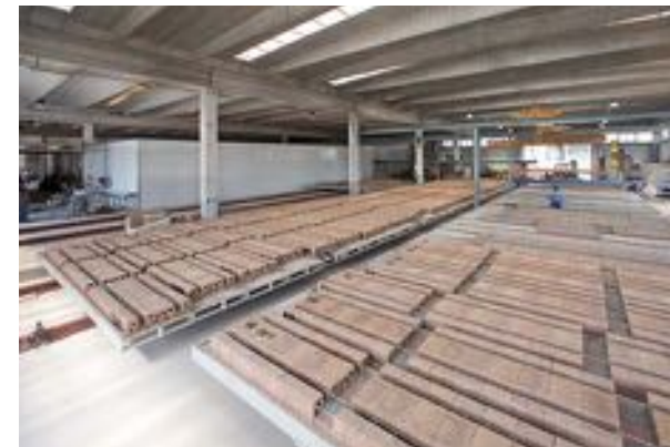
Produzione pannelli solaio
