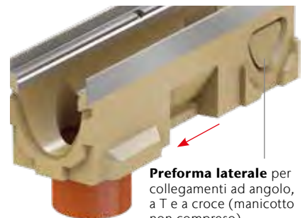
Collegamento con tubo di scarico verticale a mezzo di guarnizione integrata nella base del canale (elementi da 0,5 e 1,0 m)
