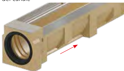
Collegamento con tubazione di ingresso attraverso testata (tipologia 2) con guarnizione integrata posta in entrata del canale
