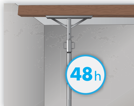
Rapida rimozione dei puntelli (es. soletta armata per consolidamento solai)
