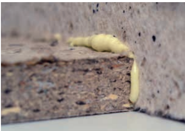
Incollaggio di pannelli truciolari
