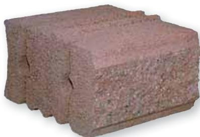
Elementi prefabbricati in calcestruzzo vibrocompresso estremamente versatili impiegati nella sistemazioni di aree verdi per il contenimento di scarpate o consolidamento di terrapieni. La posa dei singoli blocchi, da splittarsi in cantiere, è eseguita "a secco", in quanto gli stessi lavorano a gravità. La progettazione e realizzazione di un muro di contenimento deve sempre tenere conto delle spinte del terreno e degli altri carichi.
