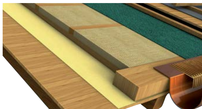
Tetto in legno con doppio assito.
