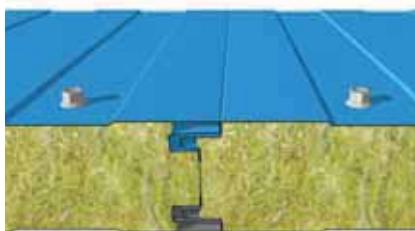
Montaggio dei pannelli in senso verticale
