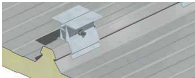
Dettaglio aggancio di accessori a copertura
