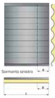
Dettaglio sistemi di sormonto
