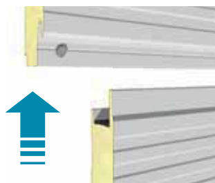
Montaggio in orizzontale (dall'alto verso il basso)
