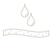
**Deformazione al contatto con l'acqua / Buckling on contact with water**Truciolare / chipboard
