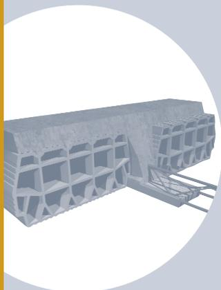
Nervatura realizzata con blocco solaio H 20x42x25 e travetto tralicciato
