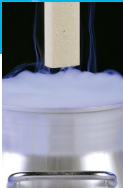
purenit resiste anche all'azoto liquido.
