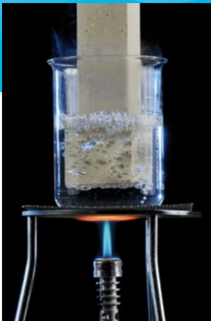
L'umidità sottopone molti materiali a sollecitazioni estreme. purenit resta stabile alla forma anche in acqua bollente.
