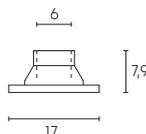
Base in termoplastico, per fissaggio a terra,
