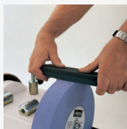
SH89490707 dispositivo per aumentare o diminuire la granatura della mola
