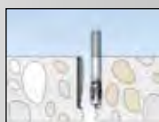
Fessurazione del supporto
