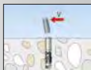
Rottura a taglio dell'acciaio
