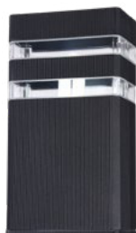
▲ O578WL-01B 1xE27 60W H: 207, W: 110, L: 100 mm, IP54
