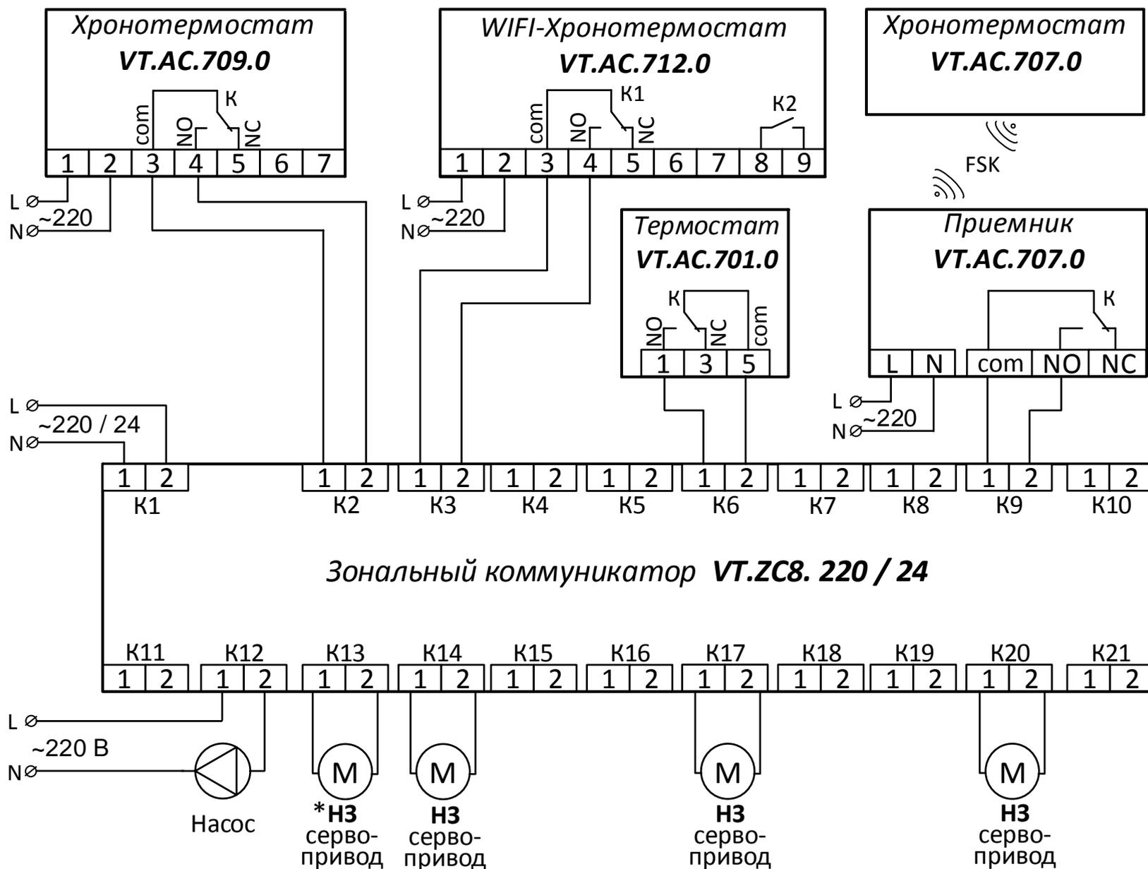
*\*Примечание: при подключении электротермических сервоприводов нормально-открытого исполнения, следует на термостате вместе с общей клеммой («com») использовать клемму с нормально-закрытым контактом («NC»), а в зональном коммуникаторе перевести нижний тумблер соответствующего канала в положение «ON» (наверх).*
