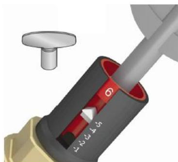
5.7. Настройка картриджа VT.PICC.G.22 также производится непосредственно на собранном стабилизаторе специальным ключом SW7 или рожковым ключом SW8 (см.рис)
