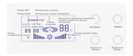
ЖК-ДИСПЛЕЙ: показывает влажность окружающего воздуха, температуру, настройки влажности и скорость ветра.
