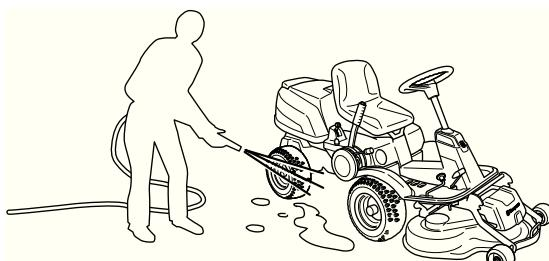
Масляные загрязнения могут быть сняты холодным обезжиривателем. Распылите тонкий слой.
