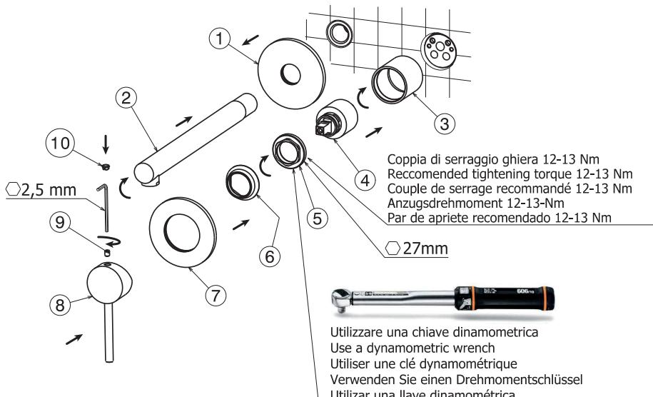
**I** INTERVENTI DI MANUTENZIONE**SOSTITUZIONE DELLA CARTUCCIA**
