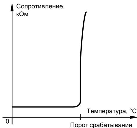
Типовой график датчика PTC
