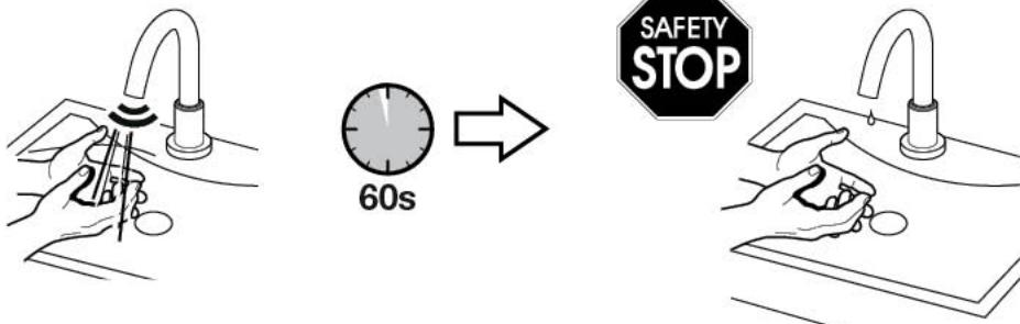
**ES** El flujo de agua se interrumpirá automáticamente pasados 60 segundos de su activación, como medida de seguridad, ante la invasión prolongada del campo de detección por parte de algún objeto. El grifo volverá a quedar operativo al retirar el objeto causante de la activación. El grifo incorpora además un sistema que asegura el cierre del paso de agua al quedarse sin alimentación eléctrica durante el uso del mismo.
