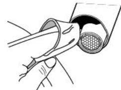
**ES** Limpiar el grifo solo con detergentes líquidos no ácidos. No utilizar ningún tipo de estropajo. Mantener limpio el visor cuidando de no rayarlo.
